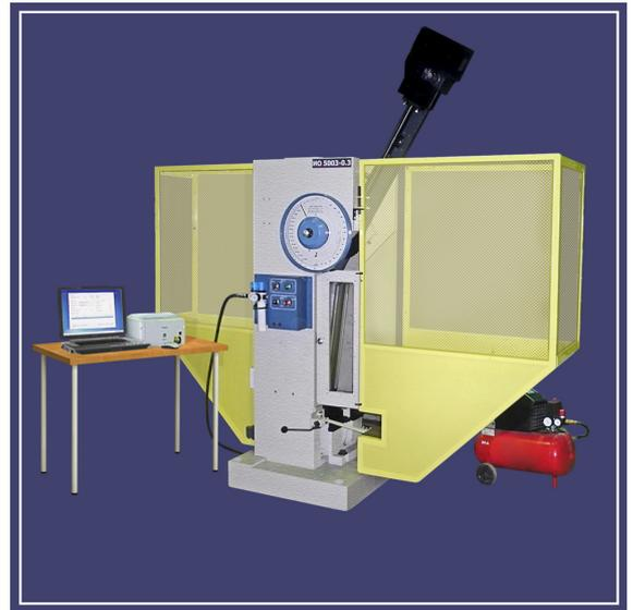
Подъем маятника в верхнее положение (фиксация заданного угла зарядки маятника) и сброс его осуществляется автоматически с помощью пневматических устройств. Результат испытания (величина энергии, затраченной на разрушение образца) фиксируется по аналоговой шкале (для всех моделей копров).
