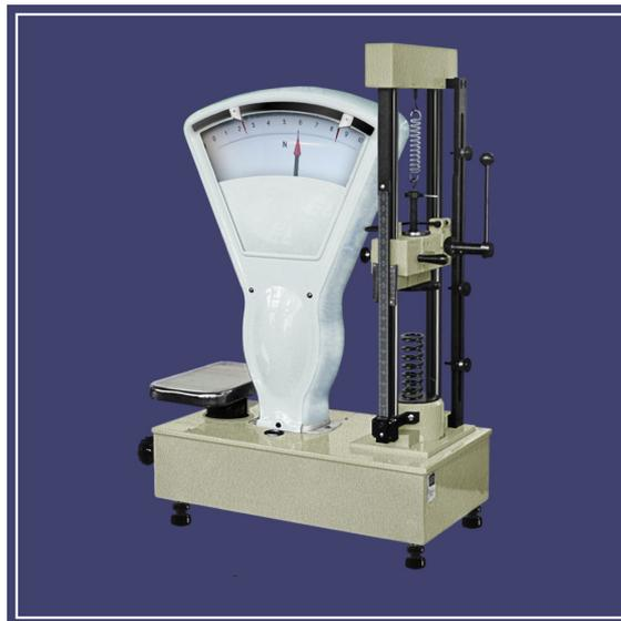
Автономные системы быстрого и медленного нагружения делают машину оперативной в обслуживании. Система заданного двухпозиционного останова перемещения нагружающей опоры позволяет снимать полную характеристику за один ход.
