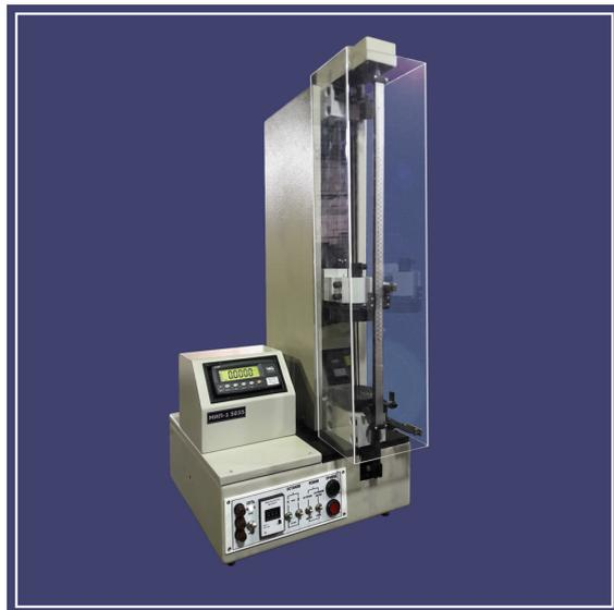
Машина имеет: встроенный реверсор, повышающий удобство обслуживания и позволяющий иметь постоянную готовность машины для испытания на сжатие и растяжение; единый измеритель деформации.
