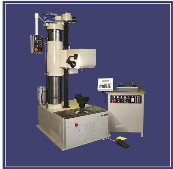
Система автоматического измерения твердости твердомера ТБ5056 измеряет твердость за счёт измерения глубины восстановленного отпечатка.
