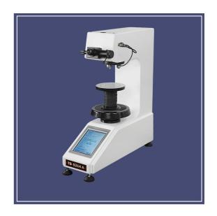
Принцип действия твердомера основан на статическом вдавливании алмазного последующим пирамидального наконечника С измерением длин диагоналей восстановленного отпечатка.
