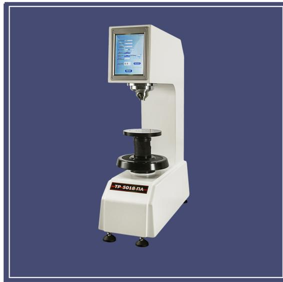
Задание предварительной и основных нагрузок, выдержка и снятие нагрузок, вывод результата на дисплее происходят в автоматическом режиме.
