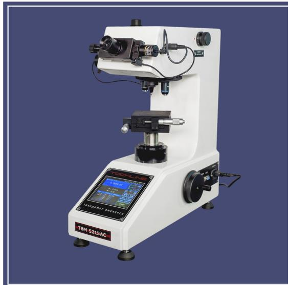
Прибор имеет автоматическую поворотную турель, электромеханический привод нагружения, электронную систему контроля нагрузки, встроенную оптическую систему. При измерениях по методу Виккерса система приложения нагрузки приборов обеспечивает приложение нагрузок 0,098; 0, 245; 0,49; 0,98; 1,96; 2,94; 4,9; 9,8; 19,6Н.
