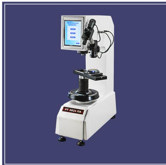
Твердомер имеет цифровой индикатор в виде жидкокристаллического дисплея, содержит микропроцессор.
