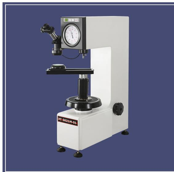
Твердомер имеет стрелочный индикатор часового типа для отображения твёрдости по Роквеллу.
